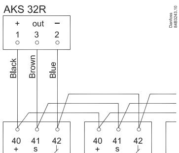
Сигнал от одного преобразователя давления могут получать до 10 контроллеров.
